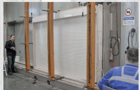
Ρολό με φυλλαράκι προφίλ αλουμινίου PPO-940 Rolling shutter with slat aluminium profile PPO-940
