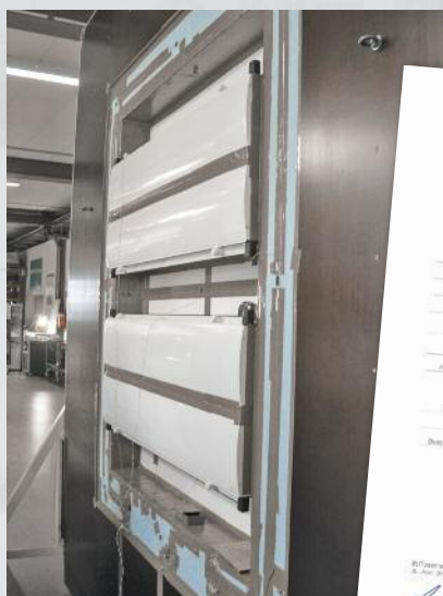
Μέτρηση συντελεστή U_{sb} Measurement of U_{sb} coefficient (ift Rosenheim)
